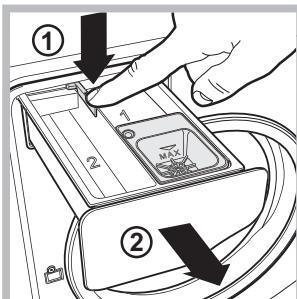
Чтобы вынуть дозатор, нажмите на язычок (1) и вытащите дозатор (2) (см. рисунок).
